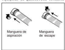
4. Conexión de la alcachofa para el acoplamiento de manguera.
